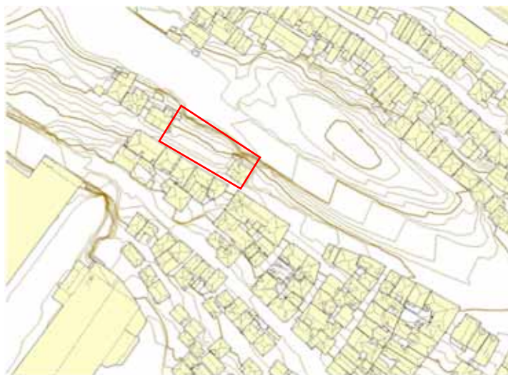
Figur 4 Terrenget på eiendommen; det er ca. 10 meter mellom fortauet i Haugeveien og gateplanet i Strangehagen.
