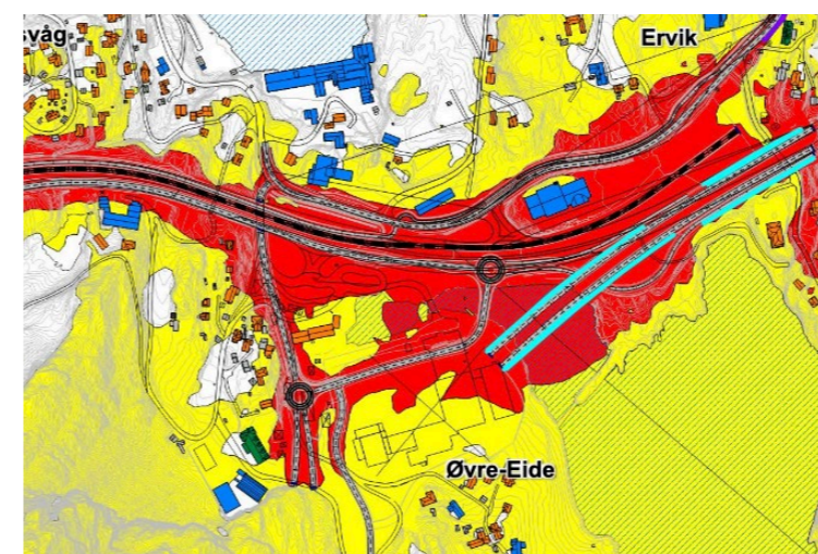
Modellering av støy ved ferdig utbygget bybanetrase og ny E39, inkl. støyskjermingstiltak. (Kilde: Bergen kommune)
